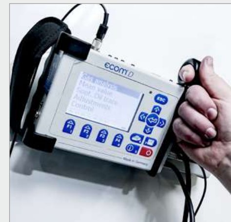
Puxar para baixo ajuda a libertar a estável montagem magnética
