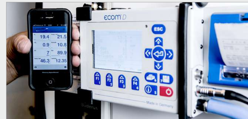
Mão livre através da transferência de dados de Wi-Fi: transmissão de dados e processamento no smartphone ou laptop / PC (aplicativos de software gratuitas)
